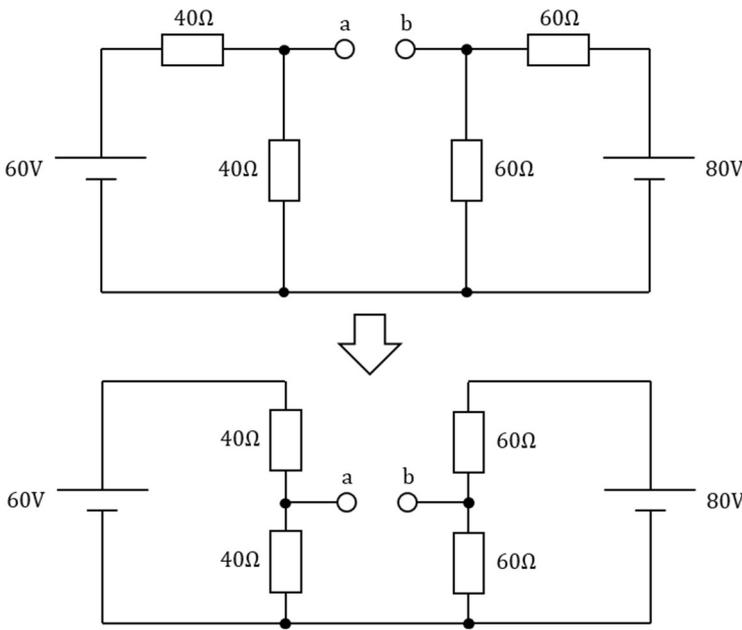
分圧式より  $V_1$  と  $V_2$  を求めると
