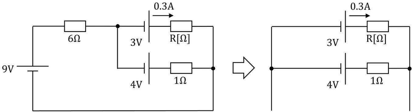
② 第一法則を適用して電流の式を立てる。抵抗の両端電圧を求める。
